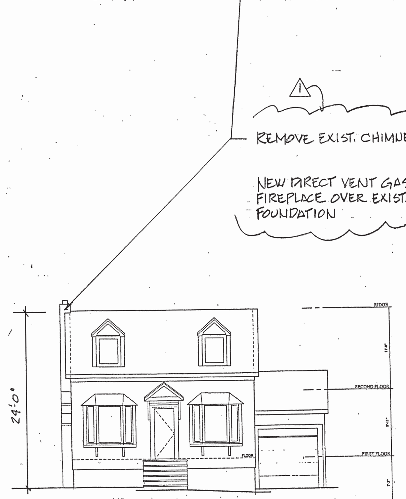
EXISTING FRONT ELEVATION SCALE: 1/8" = 1'-0"
